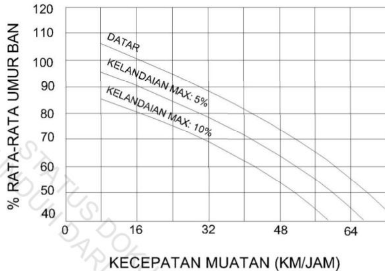
Gambar 10. Hubungan Gradien, kecepatan Truk, dan Umur Ban kendaraan
